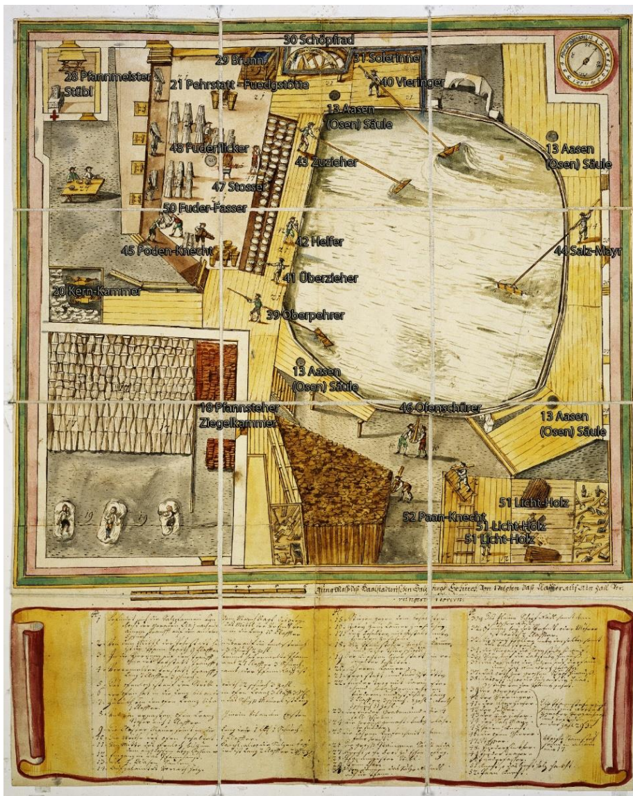
Abbildung 8 Arbeitsprozesse und technische Einrichtungen im Pfannhaus, Beschriftung auf Basis der Planlegende F. Idam, © ÖNB, Signatur PK 231 VIII C1.
